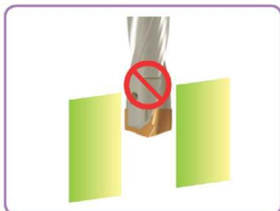
Врезание в поверхность под углом более 7 градусов (при сверлении заготовки, расположенной под углом до 7 градусов необходимо снизить подачу на примерно 30-50%).
