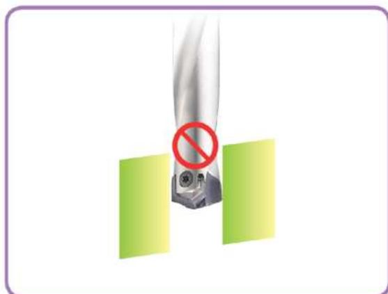
Заготовка установлена под наклоном более 7 градусов (при сверлении заготовки, расположенной под углом до 7 градусов необходимо снизить подачу на примерно 30-50%).
