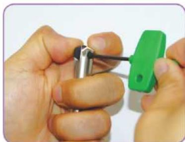
Убедиться, что пластина прижата ко дну паза, и затянуть винт её крепления, используя пасту.
