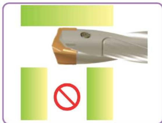
Диаметр пересекаемого отверстия превышает длину направляющей ленточки на пластине.
