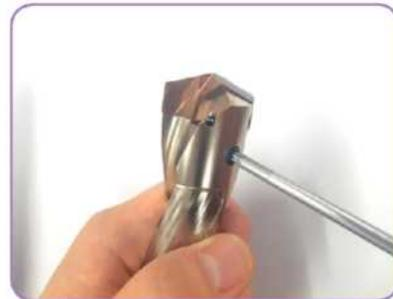
Вставить пластину в паз корпуса и прижать её к дну паза
