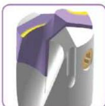
**1) Сильный износ по задней поверхности режущей пластины**
