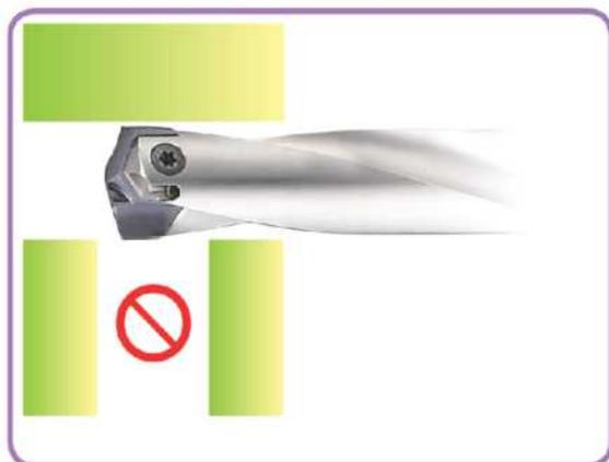
Размер пересекаемого отверстия превышает высоту пластины сверла.
